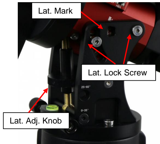
Figure 14. Adjust latitude
