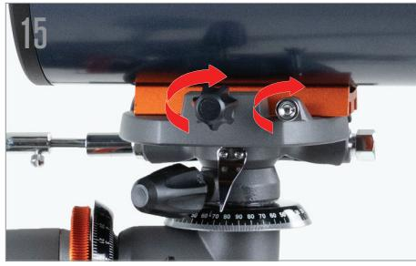
15 Centrare la coda di rondine nella montatura e serrare la vite di fissaggio. Per una maggiore sicurezza, serrare la vite di bloccaggio angolare accanto alla vite di fissaggio.
