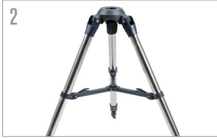
Zum Aufbau des Stativs die Beine nach außen ziehen, bis sie vollständig ausgezogen sind. Den mittleren Teil jedes der drei Stativbeine 15 bis 30,5 cm nach unten ausziehen.
