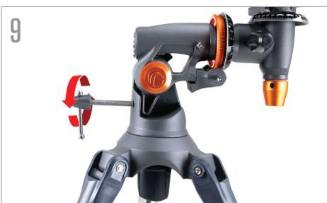
Vissez la vis d'ajustement de la monture équatoriale jusqu'à ce qu'elle touche l'intérieur de la monture.
