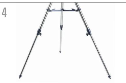
Alle drei Beine müssen gleich lang sein, um eine waagerechte Plattform für das Teleskop zu bilden.
