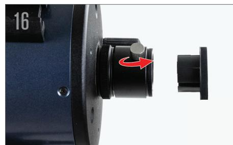
Afloje el tornillo del enfoque. Saque la tapa de plástico que cubre el extremo de la parte visual posterior.
