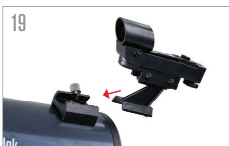
19 Far scorrere la staffa del cercatore nella scanalatura a coda di rondine sul tubo del telescopio vicino al focheeggiatore. L'ampia finestrella del cercatore dovrebbe essere rivolta verso la parte anteriore del telescopio. Fissare la staffa serrando la vite sulla scanalatura a coda di rondine.
