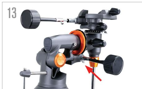
El otro cable se conecta a la varilla del engranaje del eje de A.R.
