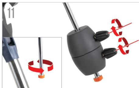
11 Rimuovere la vite di sicurezza dall'estremità della barra di contrappeso. Far scorrere i contrappesi fino a metà lungo la barra e serrare la vite di bloccaggio per fissarli in posizione. Posizionare nuovamente la vite di sicurezza.
