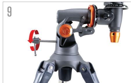
Enrosque el tornillo de ajuste de latitud en el soporte ecuatorial hasta que el tornillo esté en contacto con el interior del soporte.
